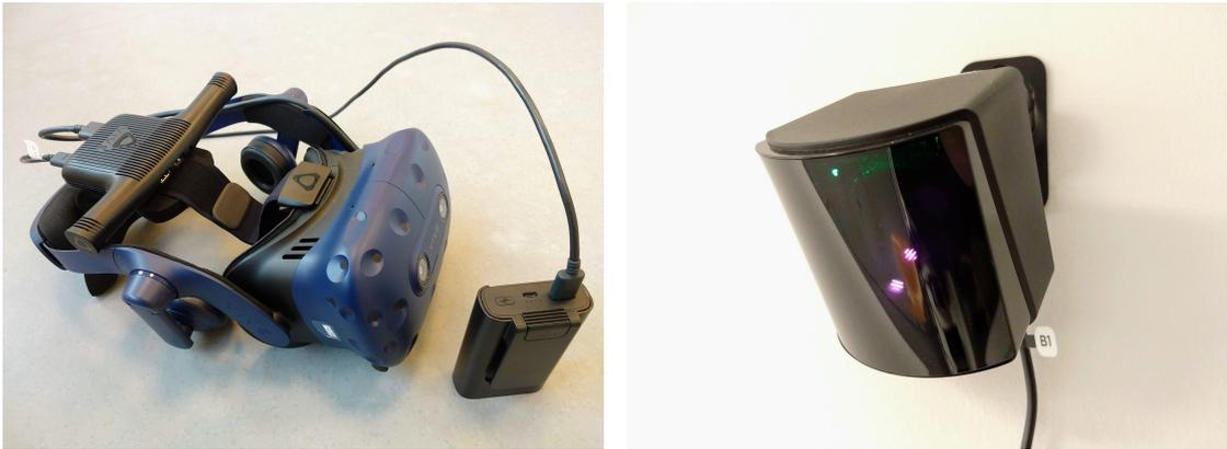
(a) Eine HTC *Vive Pro* mit Wireless-Kit. Der Funkempfänger wurde am Kopfband befestigt. (b) Eine an einer Wand angebrachte *Lighthouse*-Basisstation.
