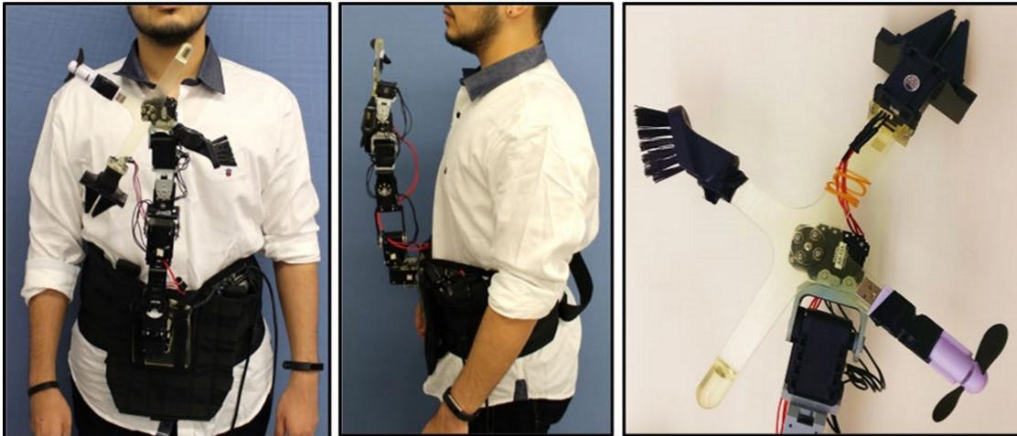
Abbildung 7.2: Der multifunktionale *Endeffektor* der *HapticHydra* [ASJR<sup>+</sup>19] bietet einen Greifarm, ein Gebläse, einen „Finger“ und eine Bürste.
